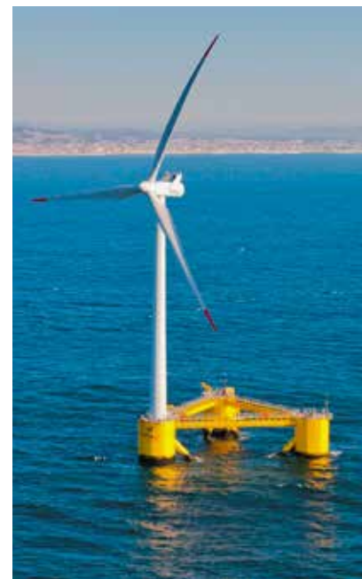
Крупнейшая ветроэнергетическая установка, смонтированная недалеко от берегов японской префектуры Фукусима, удерживается на месте четырьмя 20-тонными якорями. Агрегат способен противостоять морским волнам высотой до 20 метров
